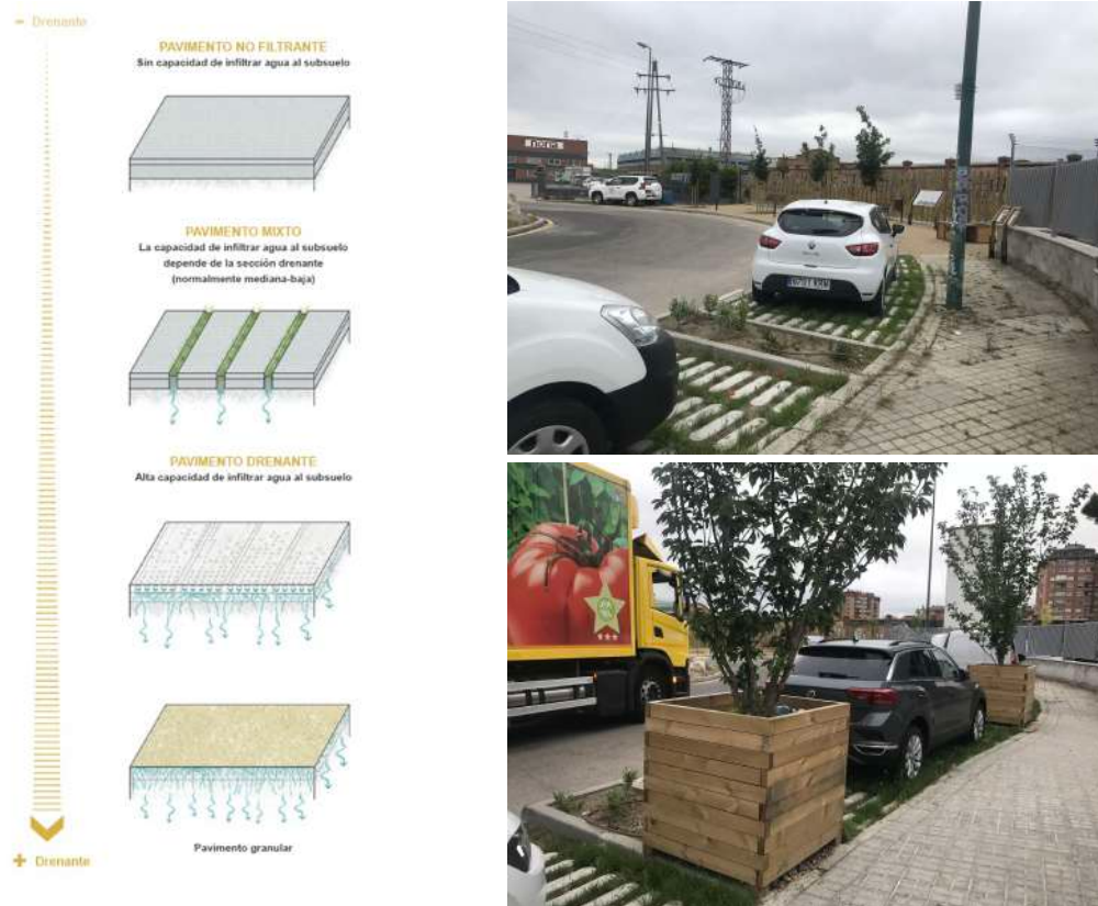
Figs. 13 y 14. A la izquierda: capacidad drenante de diversos tipos de pavimentos. A la derecha: bandas de aparcamiento filtrante en Argales (Valladolid). Fuentes: Montlleò y Spanou (2022) y M. Rosario del Caz Enjuto (UVa), respectivamente.
