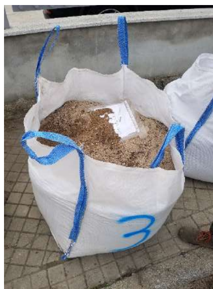
Fig. 41: Sustrato M2 compuesto por 25 % Compost + 75 % RCDs.
