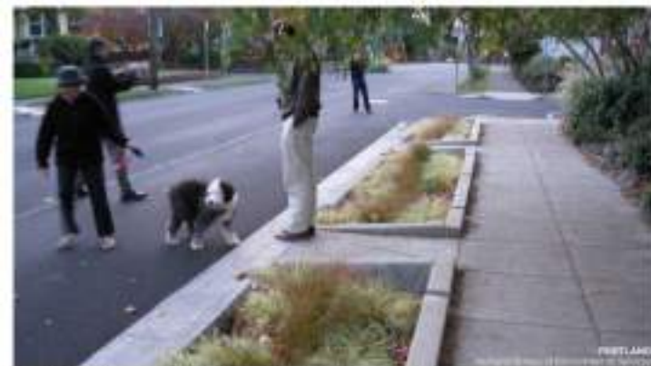
Franja filtrante en Portland, Oregón, Estados Unidos. Fuente: https://nacto.org/publication/urban-street-stormwater-guide/stormwater-elements/
